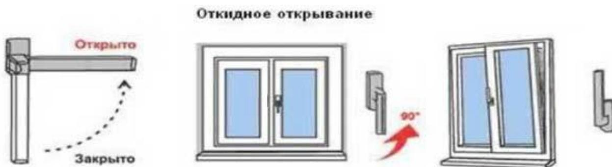
Тип открывания 2 - откидное с установленной стандартной ручкой (открывание окна на откид производится поворотом ручки на 90°).
